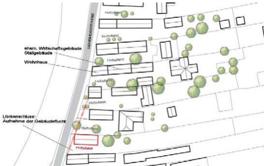
Abbildung 29: Schema der Situierung an einer Gemeindestraße, Aufnahme der Straßenflucht bei Neubauten (Quelle: Entwurfsskizzen Heigl Consulting ZT GmbH)
