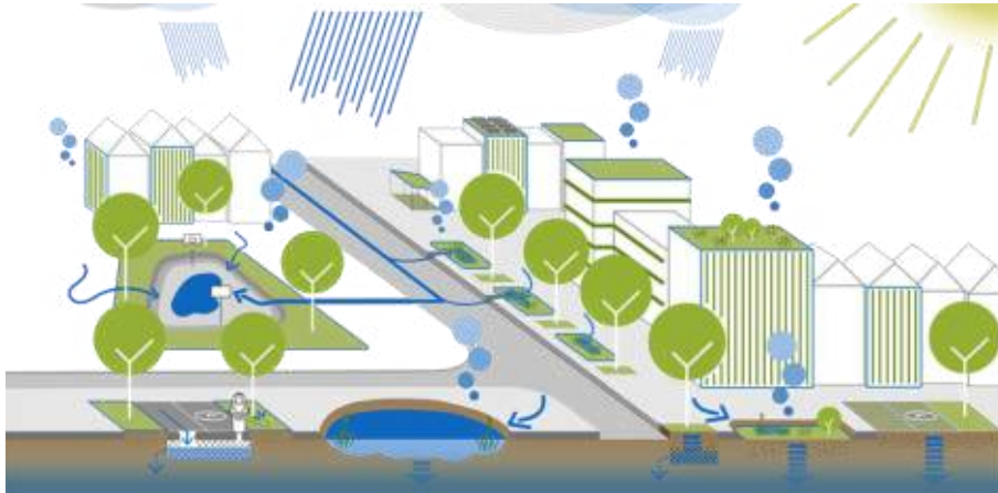
Abbildung 43: Schwammstadtprinzip (Quelle: https://www.stadtklimanatur.bayern.de/klimaanpassung/wassersensible_stadt/pic/elemente_schwammstadt.png )
